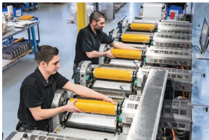
WYJĄTKOWO KRÓTKIE CZASY NARZĄDU I BŁYSKAWICZNA ZMIANA ZLECEŃ DZIĘKI LEKKIM BEZPRZEKŁADNIOWYM CYLINDROM DRUKOWYM
